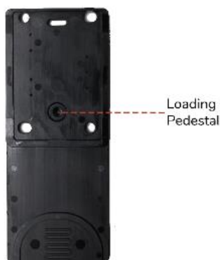
Figure 23 : Photographie d'une puce où l'emplacement du piedestal est indiqué. D'après (Fluidic Analytics, 2021e)
